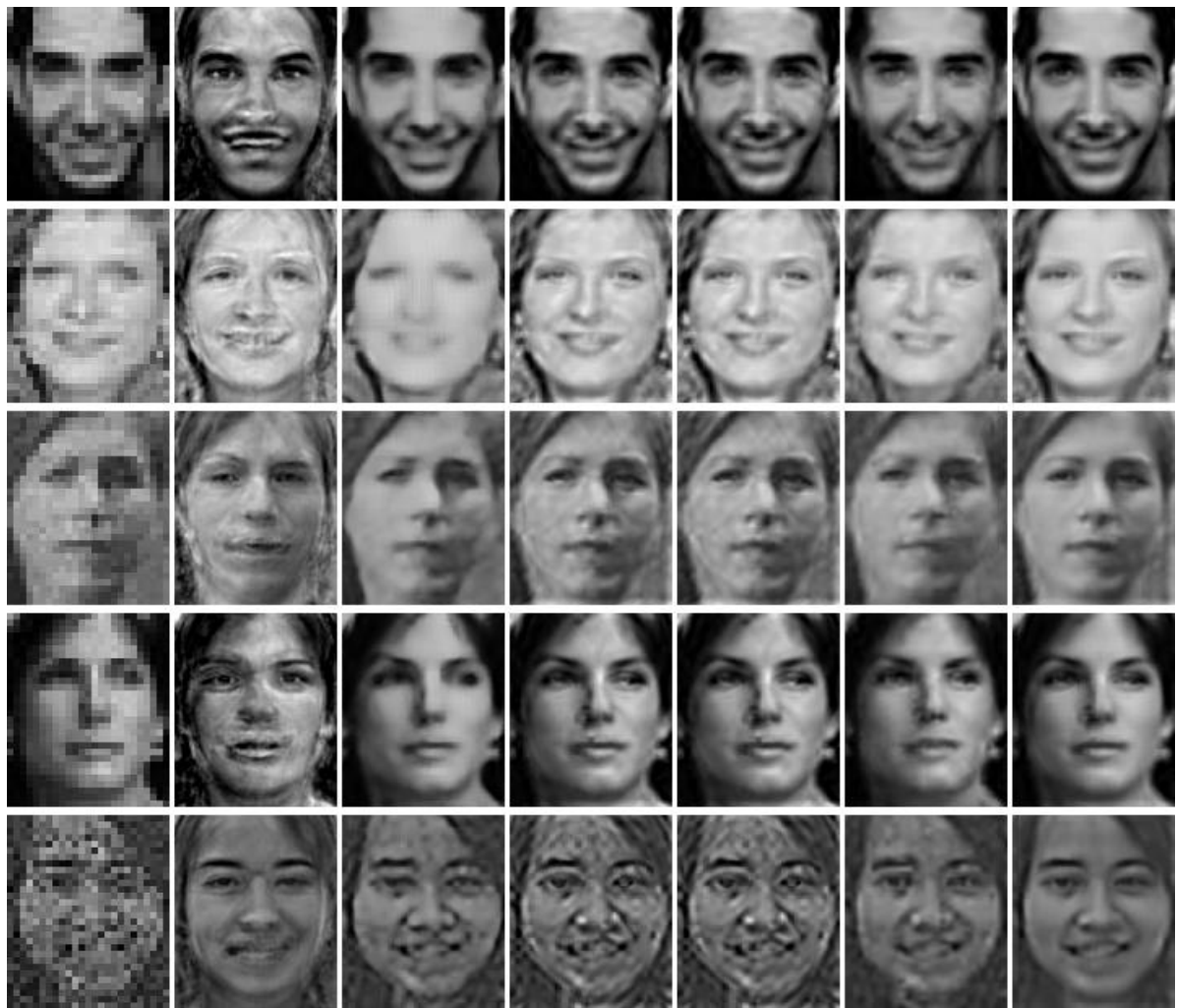
图3-15 不同算法在 CMU+MIT 人脸库上的重构结果。左到右依次为：输入低分辨率人脸图像，Wang方法的重构结果 [54] ，NE方法 [83] 的重构结果，LSR方法 [1] 的重构结果，SR方法的重构结果，DCT邻域嵌入方法的重构结果，LcR方法的重构结果。
