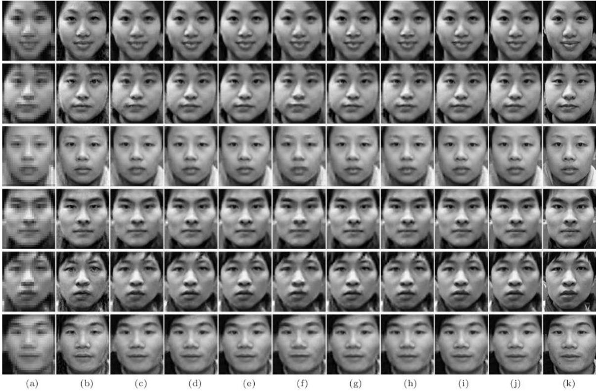
图4-5 不同算法在CAS-PEAL-R1人脸库上的超分辨率重构结果对比: (a) 输入低分辨率人脸图像; (b) Wang等人提出全局脸方法的重构结果 [54] ; (c) NE方法的重构结果 [83] ; (d) SR方法的重构结果 [8] ; (e) LcR方法的重构结果 [137, 138] ; (f) KRR方法的重构结果 [113] ; (g) GSCR方法的重构结果 [114] ; (h) LLT方法的重构结果 [65] ; (i) LR-LiSR方法的重构结果; (j) HR-LiSR方法的重构结果; (k) 原始高分辨率人脸图像。
