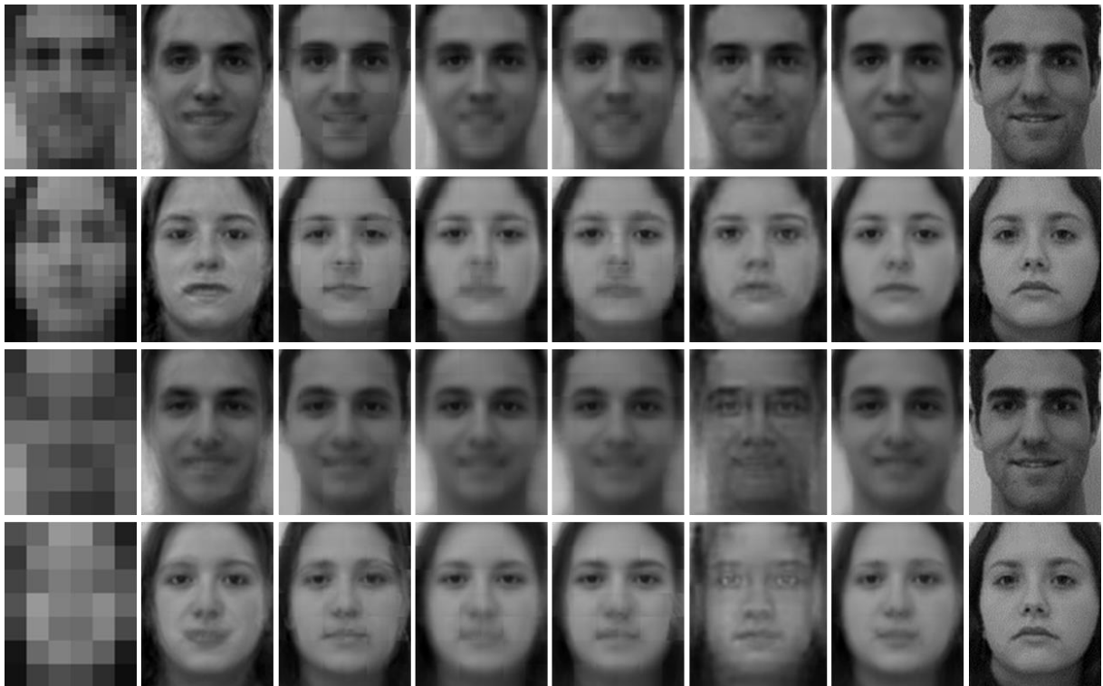
图3-9 不同算法在8倍下采样和16倍下采样下的人脸超分辨率重构结果。从左到右依次为: 输入低分辨率人脸图像, Wang方法的重构结果 [54] , NE方法 [83] 的重构结果, LSR方法 [1] 的重构结果, SR方法 [2] 的重构结果, DCT邻域嵌入方法 [68] 的重构结果, LcR方法的重构结果, PreLcR方法的重构结果, 原始高分辨率人脸图像。第一行和第二行为下采样8倍的结果, 第三行和第四行是下采样16倍的结果。
