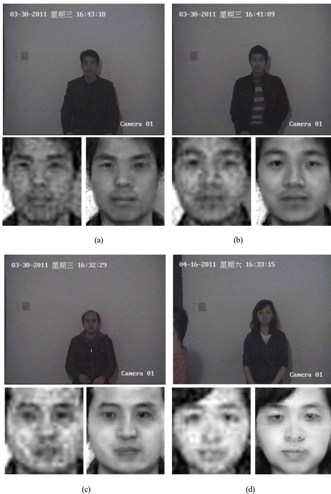
图 4-12 监控环境拍摄得到人脸图像的超分辨率重建结果。共(a)、(b)、(c)和(d)四组，每一组第一行为监控摄像头拍摄得到的人脸图像；第二行左边人脸图像为抠取出来的低分辨率人脸图像经过手工对齐和光照调整之后的人脸图像，右边为对应的人脸超分辨率重构结果图像。
